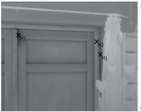
sind gegeneinander undicht. Der zerfasert wirkende dunkle Fleck links ist typisch für Zugluft.
