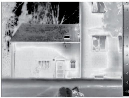
mit thermografischen Aufnahmen auf die Spur kommen. Liegen erhebliche Unterschiede der Wärmeabstrahlung innerhalb einer Fläche vor, können schlecht gedämmte Heizkörpernischen, undichte Rollladenkästen oder von außen unsichtbare Wärmebrücken der Grund sein.
