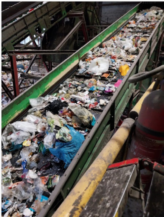
Foto Thomas Neubauer: Mit Hilfe von Lasertechnik und KI werden die Kunststoffe (aus)sortiert.
